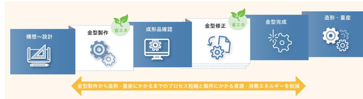
これまで、複数回にわたる修正を重ねながら金型を製作し、お客様の試作品開発を行っていました。そのため金型の製造や保管にかかる工数とコストが多く発生し、また、機械の稼働時にエネルギーも多く消費していました。しかし、3Dプリンターは金型が不要になるため、こうしたコストやエネルギーを大幅に削減することができます。さらに、スプルーやランナーが発生せず廃材の削減につながるほか、必要最小限の材料で製造することができるため、金型成形や切削加工による製造と比較すると、条件によっては材料使用量を2分の1に減らすことも可能です。POMは3Dプリント造形中に発生する反りや収縮を制御することが難しく、3Dプリンターを用いた造形はこれまで実現できていませんでしたが、独自の材料開発と材料押出法による試験を重ね、最適な条件を確立することに成功しました。当社は、将来的な3Dプリント対応可能な樹脂の種類の拡大に向けて、PBT、PPS、COCといった他の樹脂においても研究開発を進め、お客様の目的や用途に合った材料で持続可能な製品づくりを支えています。
